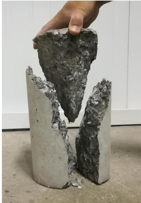
Fig. 3 – Roturas satisfactorias en probetas cilíndricas
